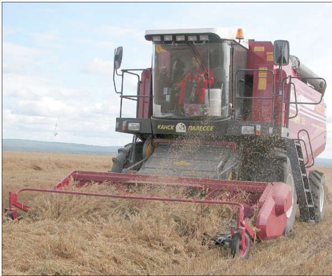
«Полесье-1218» без потерь обмолачивает сдвоенный валок.
